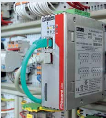
Le routeur de sécurité FL mGuard RS4000 TX/TX assure un haut niveau de sécurité d'accès
